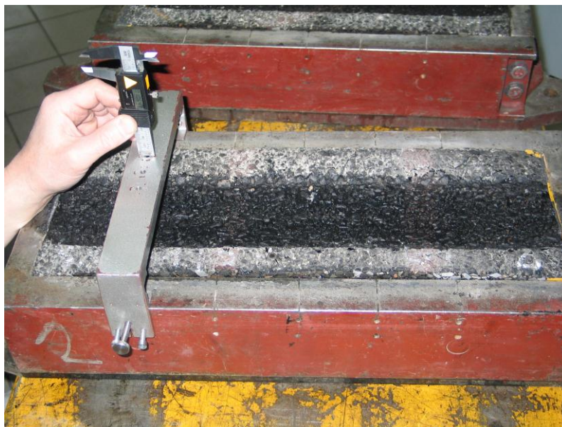
Rys.3.4. Pomiar głębokości koleiny w wybranych punktach
