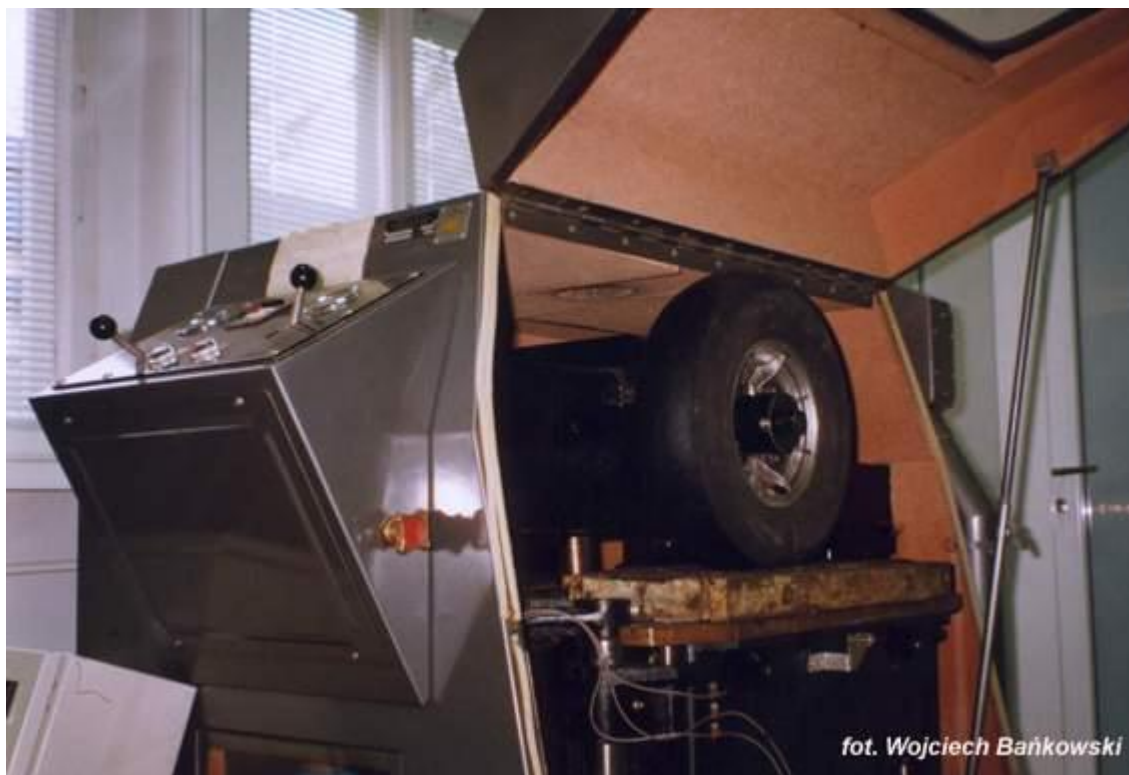
Rys.3.1. Typowy aparat do badania odporności mieszanek mineralno-asfaltowych na koleinowanie
